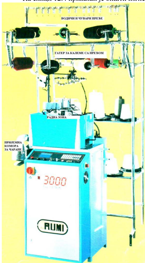
Слика 12.4: Једноцилиндрични чарапарски аутомат фирме RUMI тип 3000 FULL ELEKTRONIK
