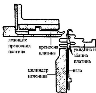
Слика 12.11: Међусобни положај цилиндра и платина
